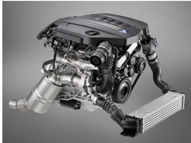
BMW N47D16 1,6 I, 70 kW 4-Zylinder, ca. 130 kg
